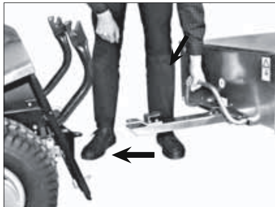
2) Anhänger auf die Anhängervorrichtung aufsetzen.
