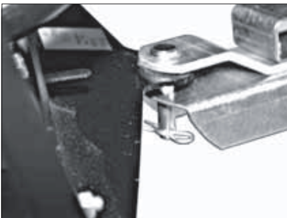
3) Anhänger an der Anhängervorrichtung mit Bolzen und Federstecker sichern.
