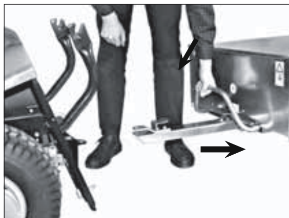
2) Anhänger von der Anhängervorrichtung ziehen.
